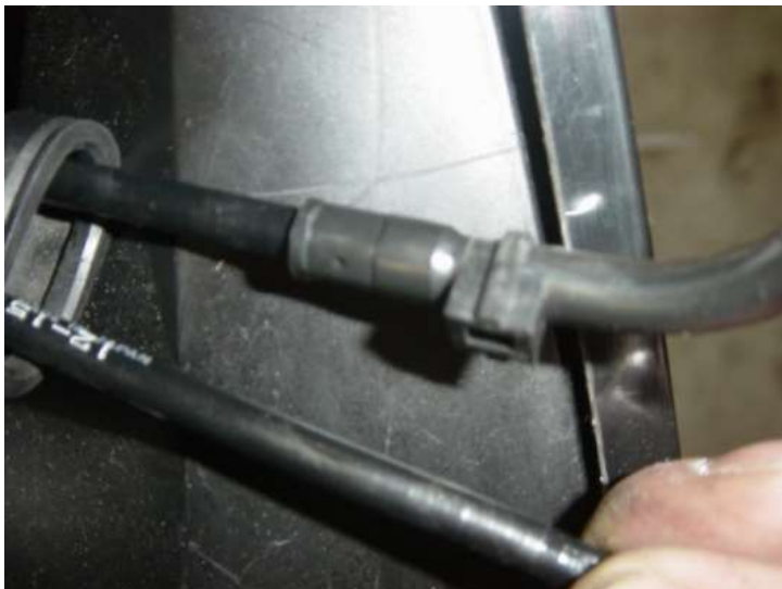
Die Hüllen der Gaszüge müssen um ca.5mm (Vor- und Rückzug) gekürzt werden
